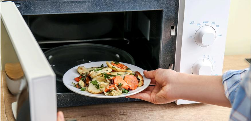
El microondas funciona mediante la emisión de ondas electromagnéticas de alta frecuencia, conocidas como microondas, que interactúan con las moléculas de agua presentes en los alimentos. Estas ondas hacen que las moléculas de agua se muevan rápidamente, lo que genera calor y calienta los alimentos de manera uniforme. Este proceso es mucho más rápido que el de un horno tradicional, ya que el microondas penetra directamente en el alimento, calentándolo desde el interior hacia el exterior.
